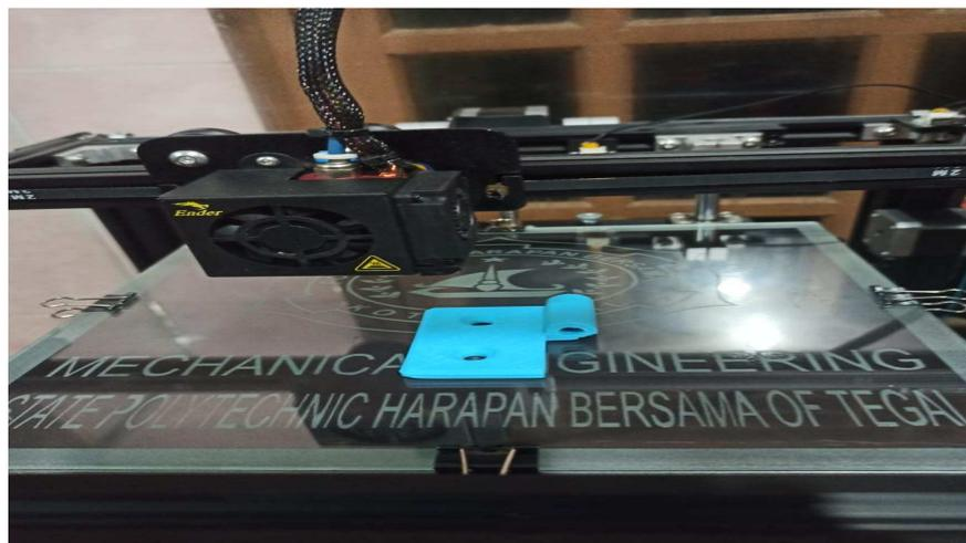
Gambar 4. 45 Pencetakan Hinge
