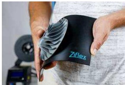
Gambar 2. 21 Proses Pengangkatan Objek.
