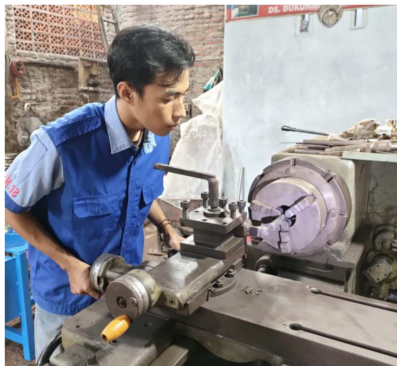
Gambar 3.13 Meratakan spesimen. (Dokumentasi 2021)
