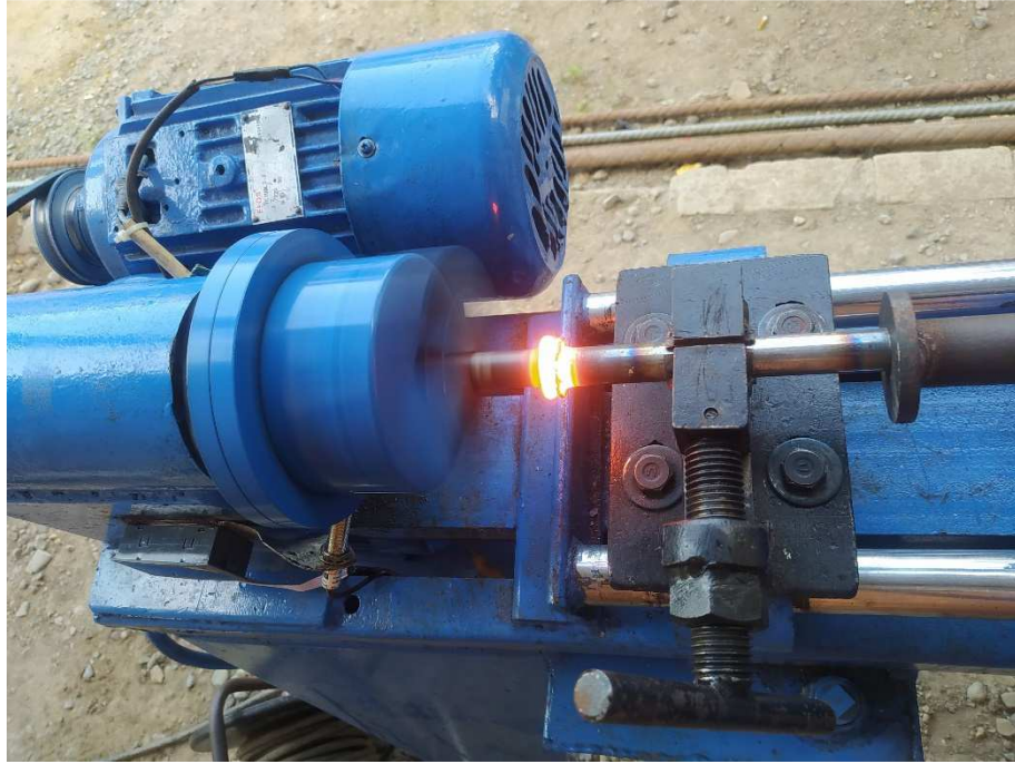
Gambar 3.20 Proses Pengelasan. (Dokumentasi 2021)
