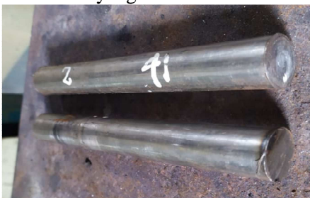
Gambar 4. Baja ST 41 (Dokumentasi 2021)
