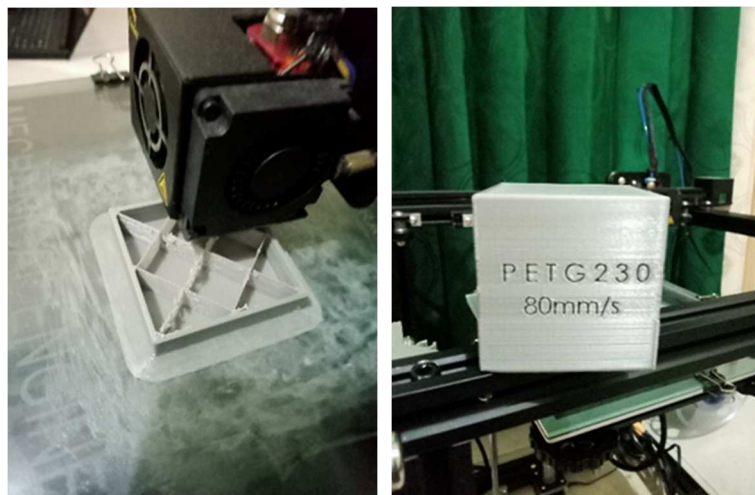
Gambar 4. 13 Pengujian Pada Kecepatan 80 mm/s
