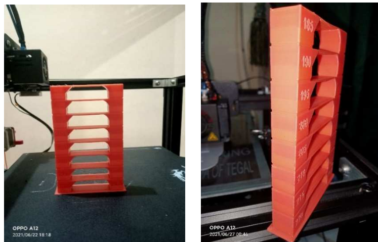
Gambar 4. 1 Kotak bertingkat dengan suhu yang berbeda
