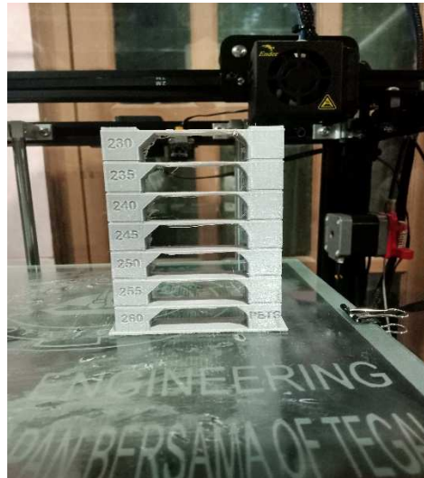
Gambar 4. 8 kotak bertingkat dengan suhu berbeda menggunakan filament PETG (Dokumentasi,2021).
