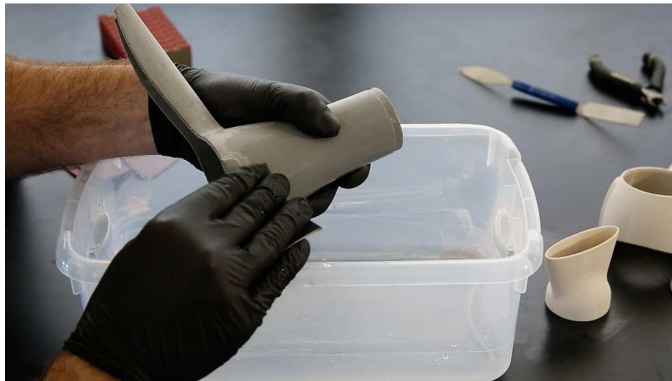
Gambar 2. 16 Proses pencucian objek 3D print (tidak wajib).
