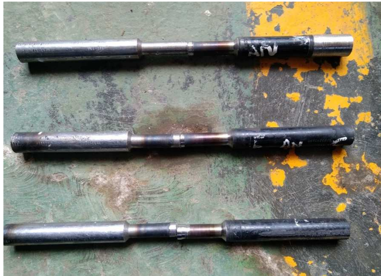
Gambar 3.24 Hasil spesimen uji tarik (Dokumentasi 2021)
