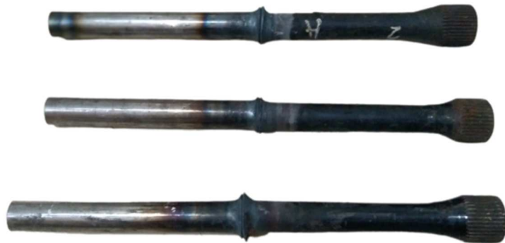
Gambar 3.21 Hasil pengelasan dengan 2300 rpm (Dokumentasi 2021)
