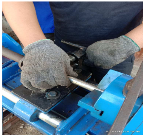
Gambar 3.15 Memasang benda kerja pada kedua cekam (Dokumentasi 2021)
