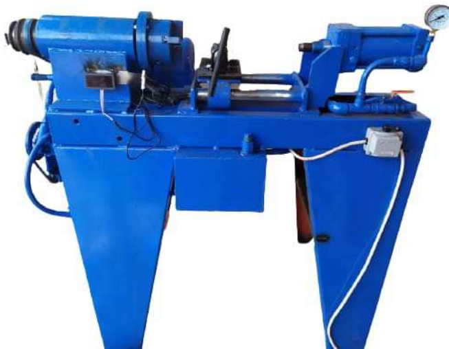
Gambar 3.2 Mesin Las Gesek (Dokumentasi 2021)
