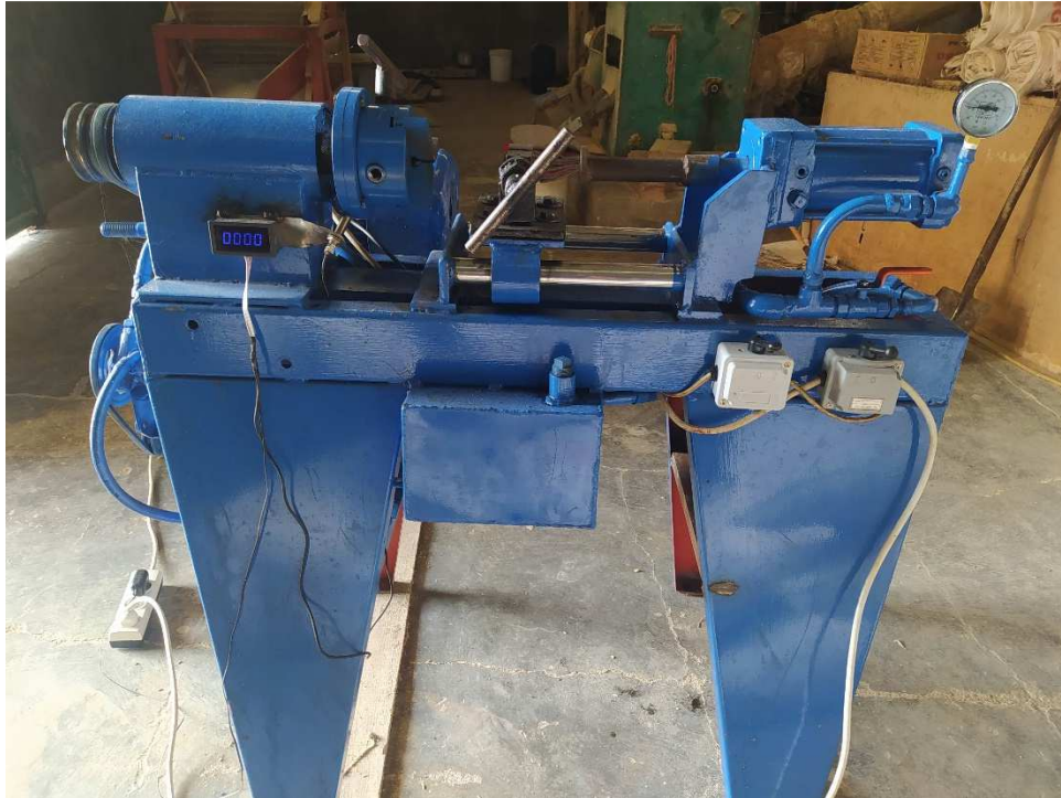
Gambar 2.2 Mesin Las Gesek (Dokumentasi 2021)
