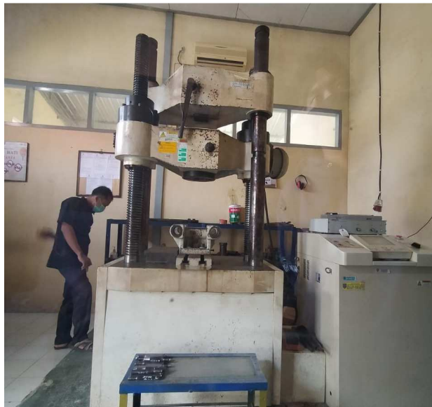
Gambar 3.9 Mesin Uji Tarik (Dokumentasi 2021)
