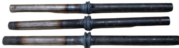
Gambar 3.22 Hasil pengelasan dengan 3100 rpm (Dokumentasi 2021)
