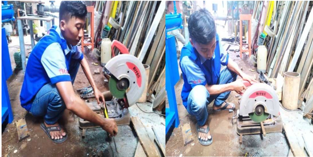
Gambar 3.11 Mengukur dan memotong benda kerja. (Dokumentasi, 2021).
