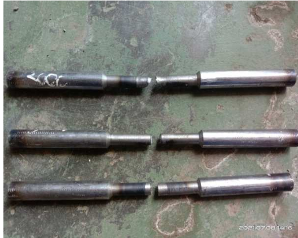
Gambar 3.23 Hasil pengujian tarik rpm 2300. (Dokumentasi, 2021).
