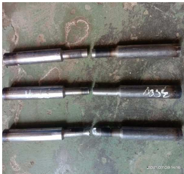
Gambar 3.24 Hasil pengujian tarik rpm 3100. (Dokumentasi, 2021).
