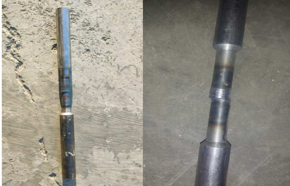
Gambar 3.21 Hasil pengelasan rpm 2300 dan rpm 3100. (Dokumentasi, 2021).
