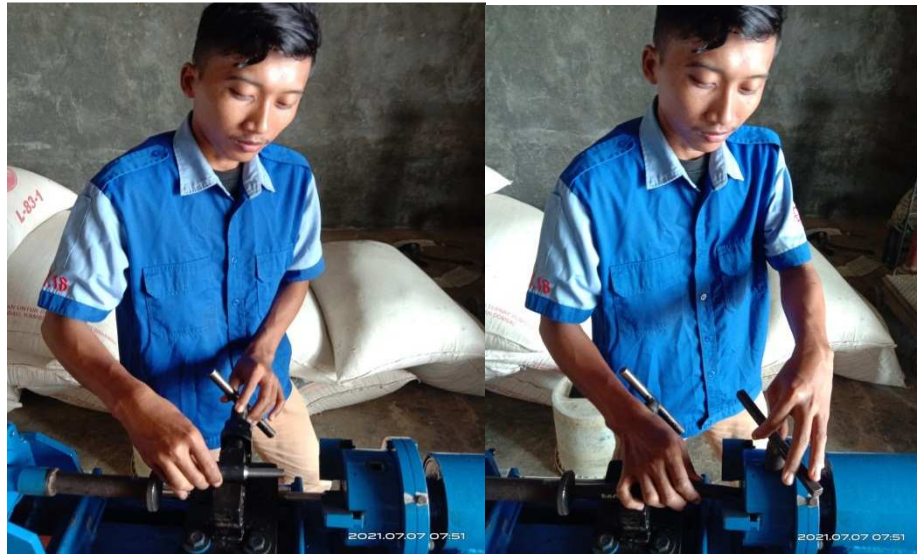
Gambar 3.15 Memasang benda kerja. (Dokumentasi, 2021).
