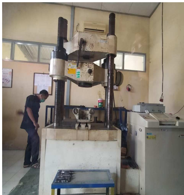
Gambar 3.9 Mesin Uji Tarik Tipe Shimadzu UH 1000 Kni. (Dokumentasi, 2021).
