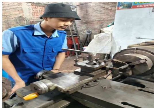
Gambar 3.12 Meratakan Benda Kerja Sumber. (Dokumentasi, 2021)
