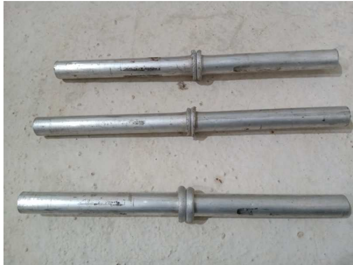
Gambar 3.20 Hasil Pengelasan Aluminium Kecepatan 3100 Rpm
