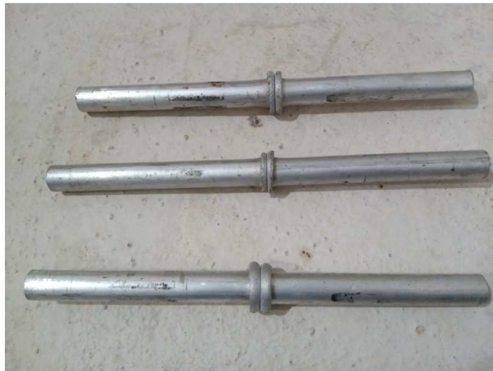
Gambar 3.19 Hasil Pengelasan Aluminium Kecepatan 2300 Rpm Sumber. (Dokumentasi, 2021)
