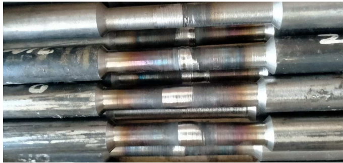
Tarik 3.22 Hasil Spesimen Setelah Di Bubut Sumber. (Dokumentasi, 2021)
