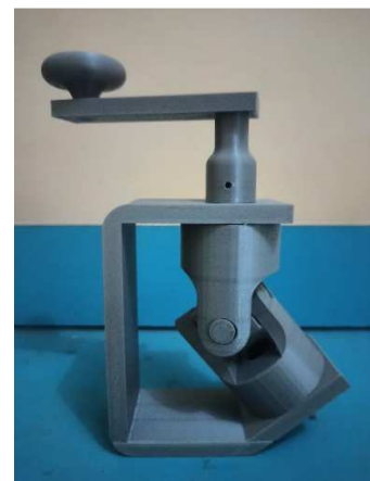
Gambar 3. Hasil cetak Universal Joint dengan kecepatan 30mm/s.
