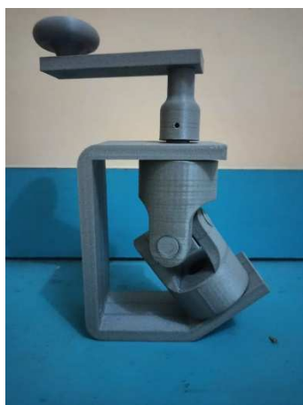
Gambar 5. Hasil cetak Universal Joint dengan kecepatan 80mm/s.
