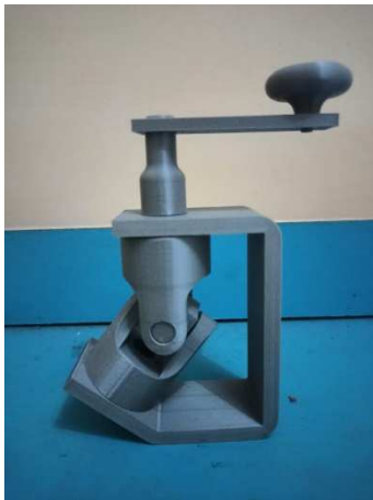
Gambar 4. Hasil Cetak Universal Joint dengan kecepatan 60mm/s.
