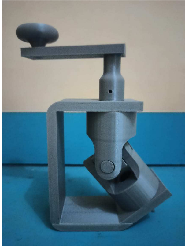
Gambar 4. 57 Hasil pencetakan kecepatan 30mm/s
