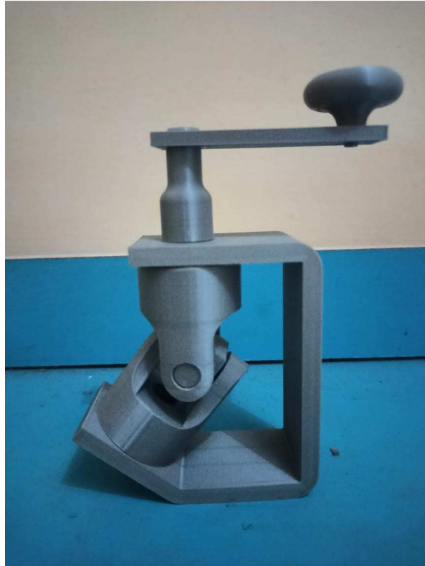
Gambar 4. 58 Hasil pencetakan kecepatan 60mm/s
