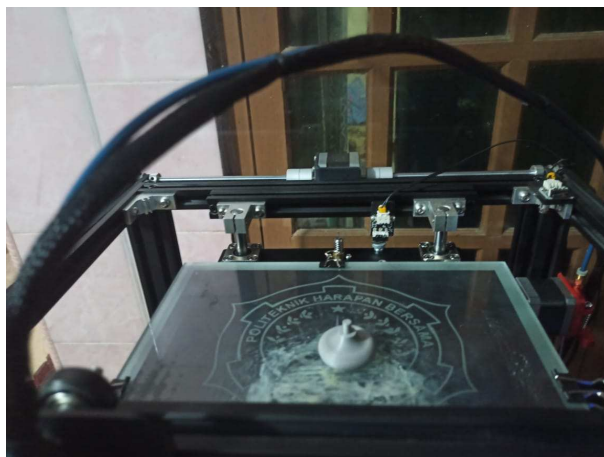
Gambar 4. 14 Pencetakan part crank knob
