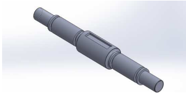
Gambar 2.4. Poros utama (Ardi Noerpamoengkas, 2013)
