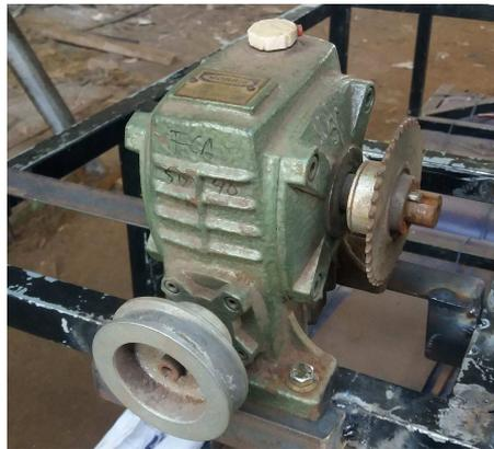
Gambar 2.9 *Gearbox* pada Robot Kendali Pengangkut Sampah (Dokumentasi, 2021)
