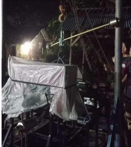
Gambar 4.5 Proses Penimbangan Robot Kendali Pengangkut Sampah
