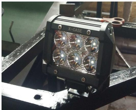
Gambar 2.6 Lampu LED pada Robot Kendali Pengangkut Sampah (Dokumentasi, 2021)
