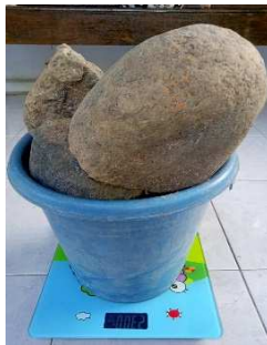
Gambar 4.2 Proses Penimbangan Beban Pelampung
