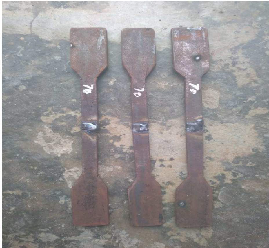
Gambar 3. 4 Pengelasan Arus 70 Amper ( Dokumentasi, 2021)
