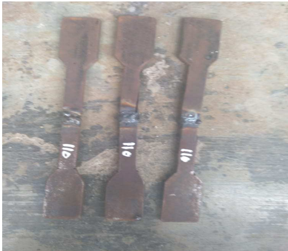
Gambar 3. 8 Pengelasan Arus 110 Ampere
