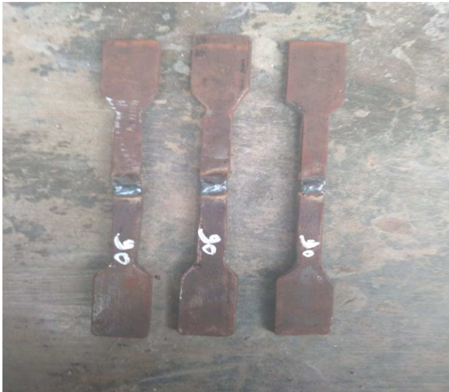
Gambar 3. 6 Pengelasan Arus 90 Ampere.
