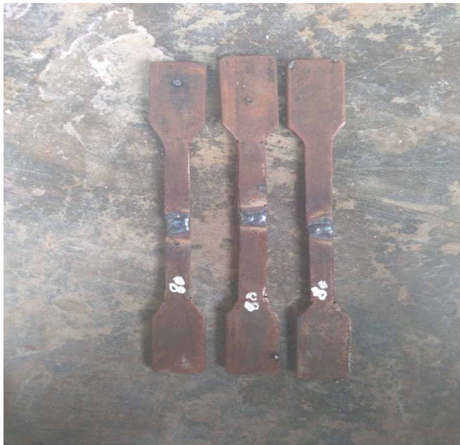
Gambar 3. 5 Pengelasan Arus 80 Ampere
