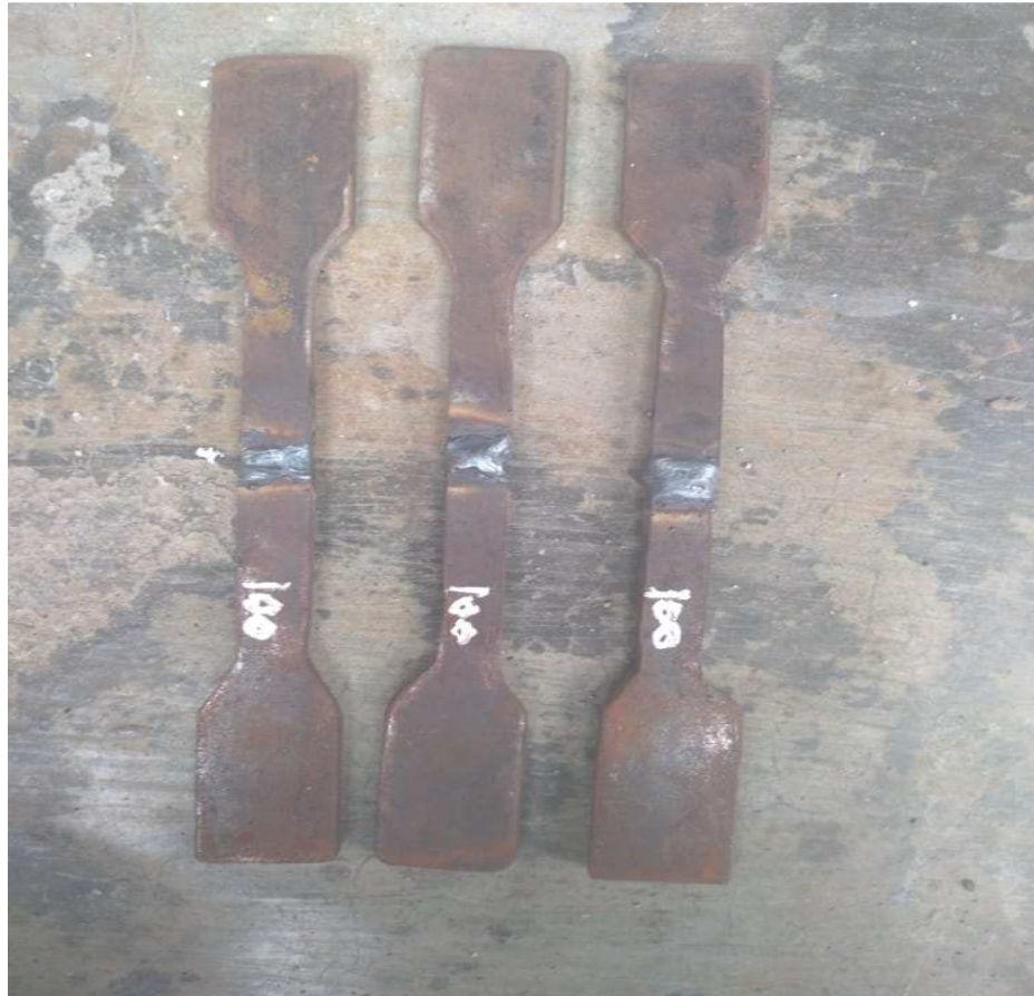
Gambar 3. 7 Pengelasan Arus 100 Ampere
