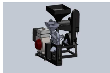
Gambar 1. Rancangan mesin penggiling dan penepung
