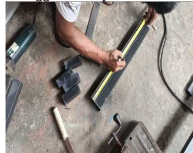
Gambar 3. pengukuran sumbu tengah besi
