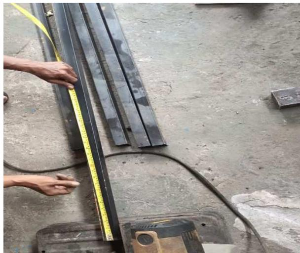
Gambar 4.3 Pengukuran besi menggunakan meteran
