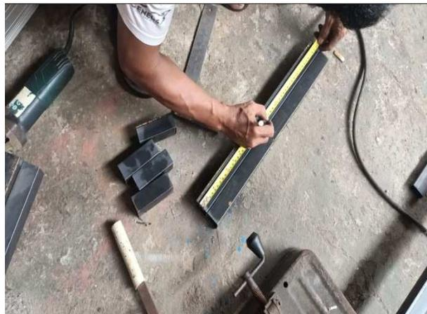
Gambar 4.5 pengukuran sumbu tengah besi
