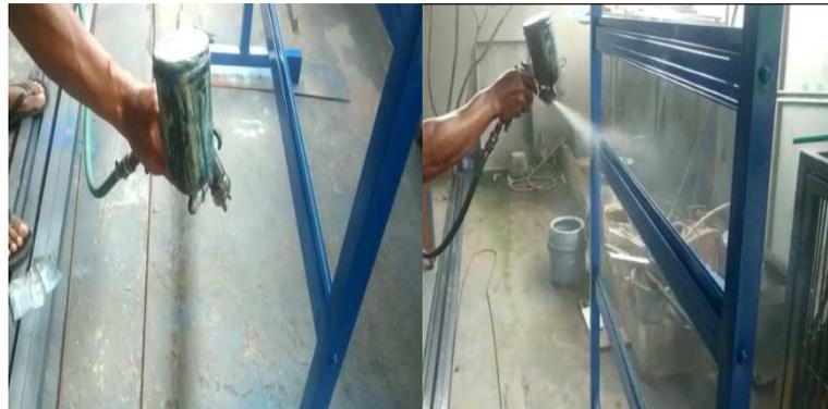
Gambar 4.9 Proses pengecatan besi kerangka
