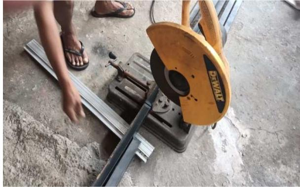
Gambar 4.4 Pemotongan besi menggunakan gerinda duduk
