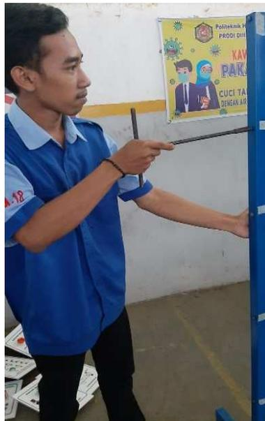
Gambar 4.14 pemasangan baut pada tiap sisi rangka
