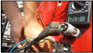
Gambar 4. Proses pengujian arus yang keluar
