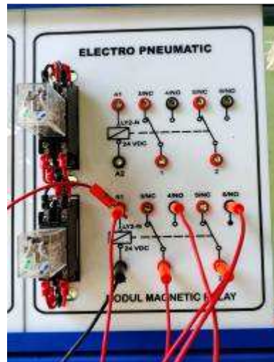
Gambar 4.13 Pemasangan kabel pada relay (dokumentasi, 2021)
