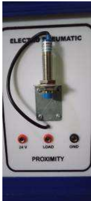
Gambar 4.21 Pemasangan kabel pada proximiti (dokumen, 2021)
