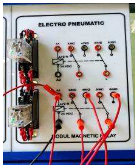
Gambar 4.20 Pemasangan kabel pada relay (dokumentasi, 2021)
