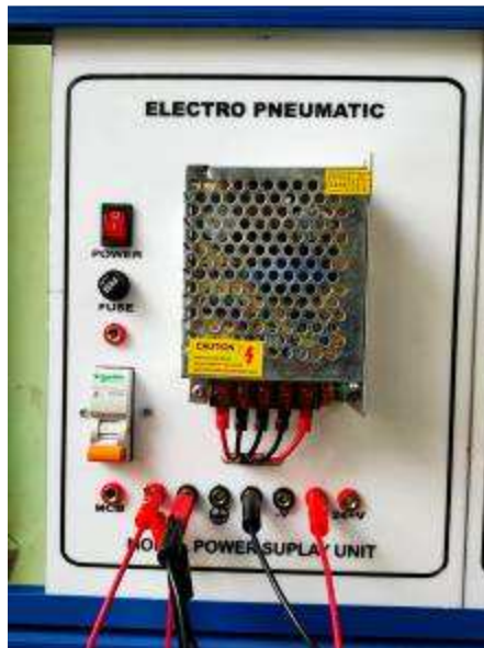
Gambar 4.17 Pemasangan kabel ke power suplay (dokumentasi, 2021)
