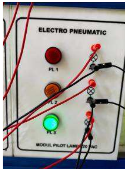
Gambar 4.34 Lampu hijau menyala karena ujung cylinder menyentuh proximity (dokumentasi 2021)
