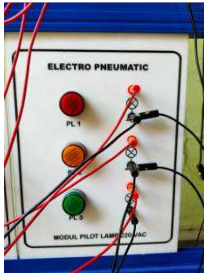
Gambar 4.23 Pemasangan kabel pada lampu (dokumentasi, 2021)
