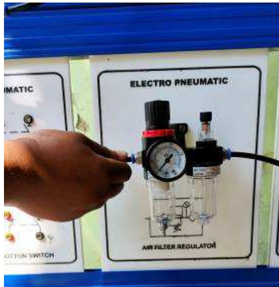
Gambar 4.6 Pemasangan selang di regulator (dokumentasi, 2021)
