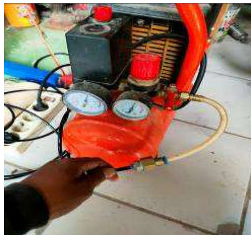
Gambar 4.5 Pemasangan selang ke compressor (dokumentasi, 2021)
