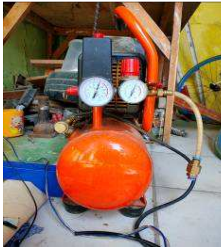
Gambar 4.25 Pengisian tabung penyimpanan kompresor (dokumentasi, 2021)
