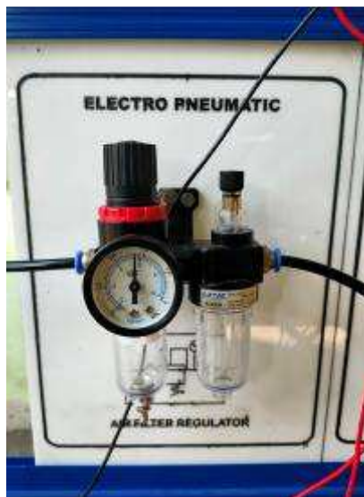
Gambar 4.26 Aliran angin pada air filter regulator (dokumentasi, 2021)
