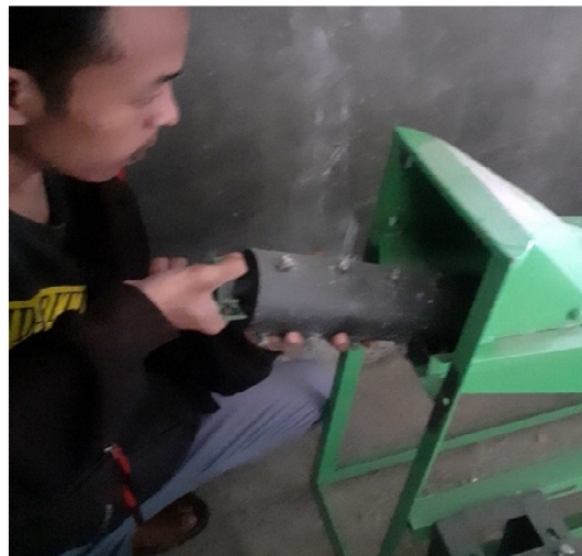
Gambar 3.11 proses pemasangan mata pisau jenis horizontal
