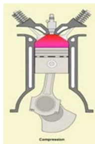
Gambar 2. 7 Langkah kompresi mesin motor bensin 4 langkah (Ilham, 2016)
