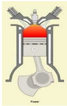
Gambar 2. 8 Langkah usaha mesin motor bensin 4 langkah (Ilham, 2016)
