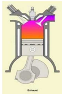
Gambar 2. 9 Langkah buang mesin motor bensin 4 langkah (Ilham, 2016)
