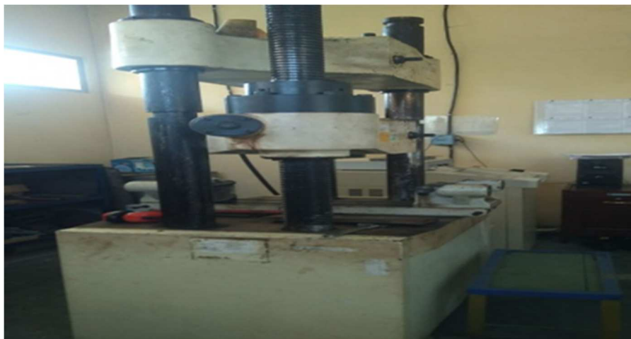
Gambar 3.2. Mesin uji tarik (UPTD Laboratorium Kab. Tegal, 2021)
