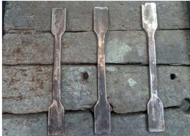
Gambar 3.5. Spesimen uji tarik (Dokumentasi. 2021)
