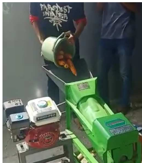
Gambar 3.14 pemasukan jagung kedalam mesin pemipil
