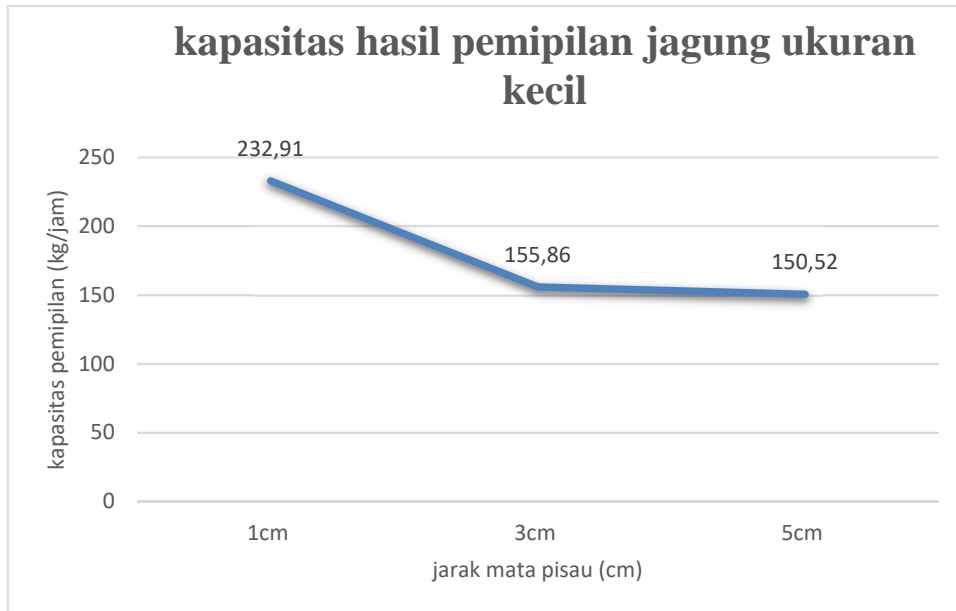
Gambar 4.1 grafik kapasitas pemipilan jagung ukuran kecil dengan variasi jarak mata pisau
