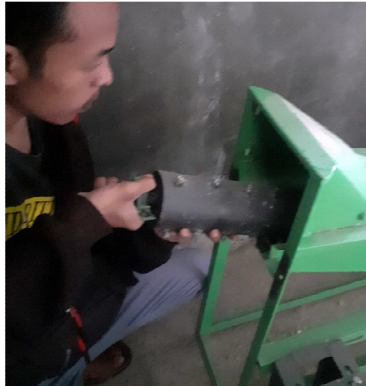
Gambar 3.11 pemasangan mata pisau jenis spiral
