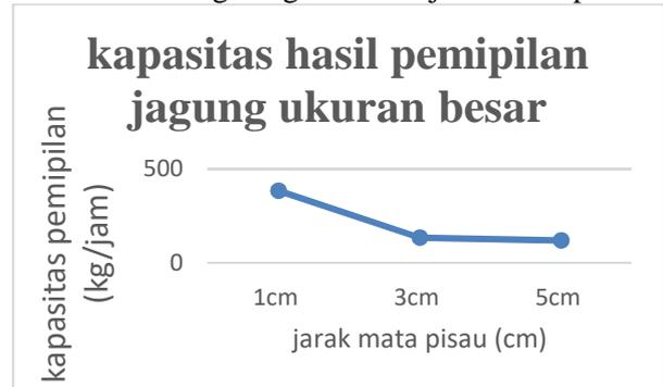
Gambar 4.10 grafik kapasitas pemipilan jagung ukuran besar dengan variasi jarak mata pisau
