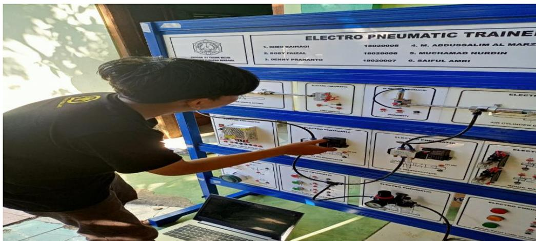
Gambar 4.8 pengujian solenoida secara manual
