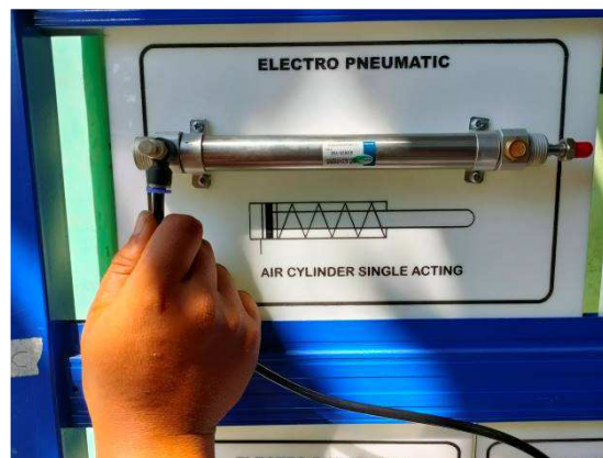
Gambar 4.8 pemasangan selang di silinder (sumber: dokumentasi 2021)
