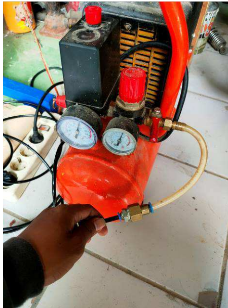
Gambar 4.5 pemasangan selang ke compressor (sumber: dokumentasi 2021)
