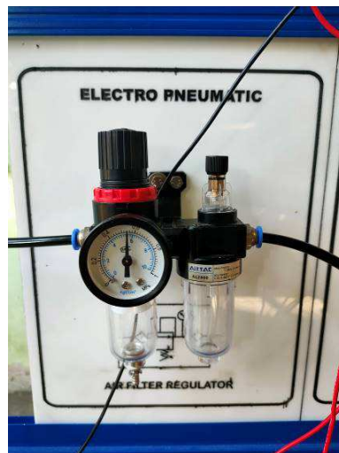
Gambar 4.26 aliran angin pada air filter regulator (sumber: dokumentasi 2021)
