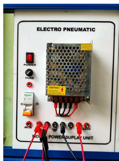
Gambar 4.10 pemasangan kabel ke power suplay (sumber: dokumentasi 2021)
