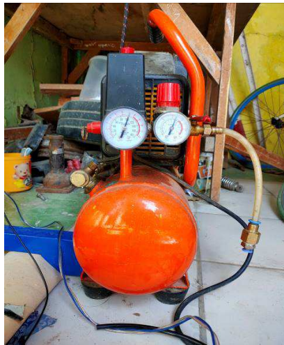
Gambar 4.25 pengisian tabung penyimpanan kompresor (sumber: dokumentasi 2021)
