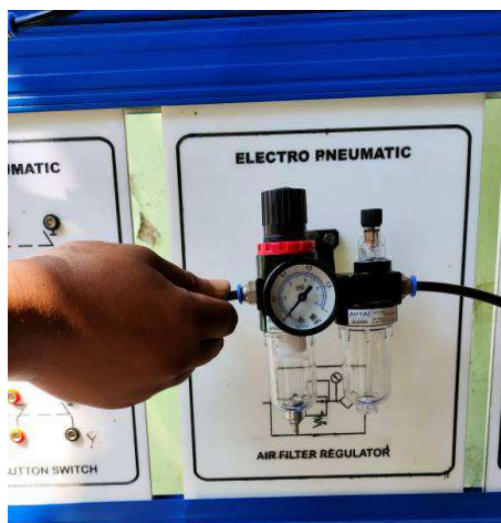
Gambar 4.6 pemasangan selang di regulator (sumber: dokumentasi 2021)
