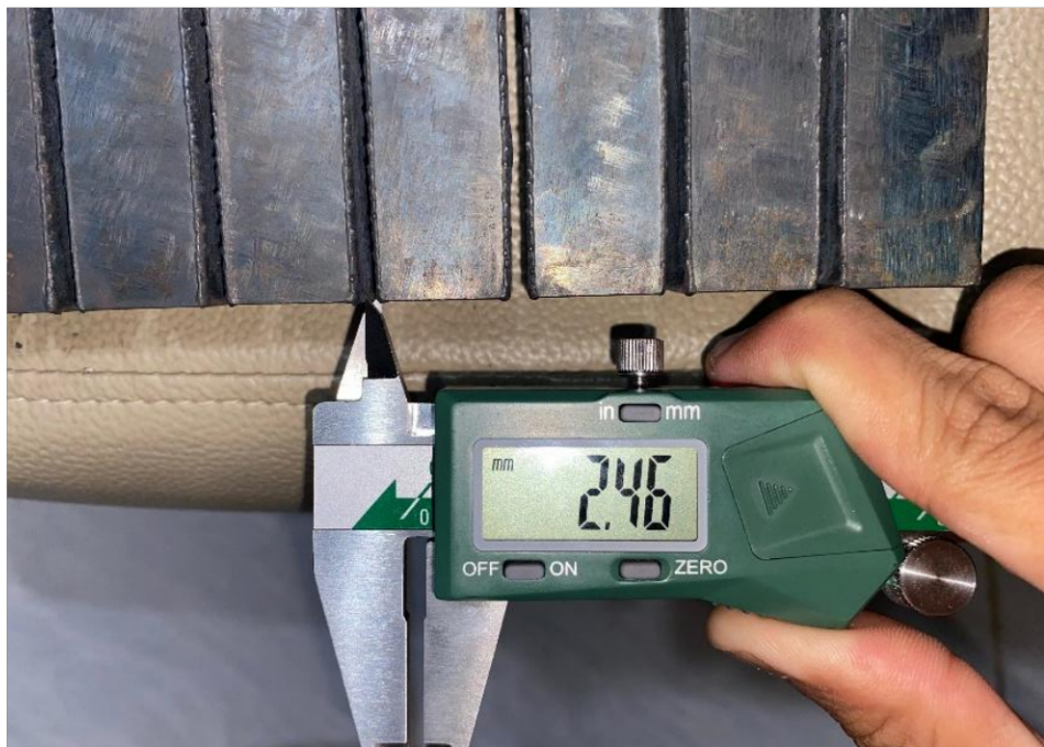
Gambar 4.2 Hasil Pemotongan 60 A dengan Tekanan 3,5 Bar
