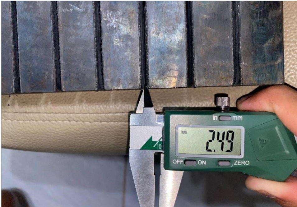
Gambar 4.6 Hasil Pemotongan 60 A dengan Tekanan 4 Bar
