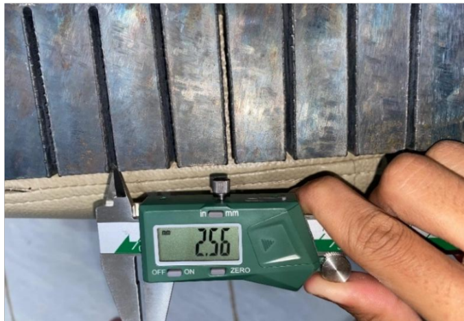
Gambar 4.2 Hasil Pemotongan 55 A dengan Tekanan 3,5 Bar
