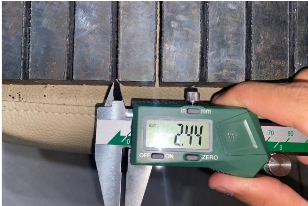
Gambar 4.4 Hasil Pemotongan 60 A dengan Tekanan 3 Bar
