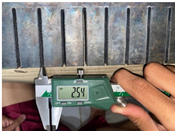
Gambar 4.3 Hasil Pemotongan 55 A dengan Tekanan 4 Bar
