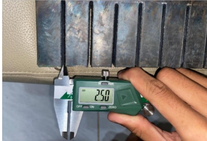
Gambar 4.1 Hasil Pemotongan 55 A dengan Tekanan 3 Bar
