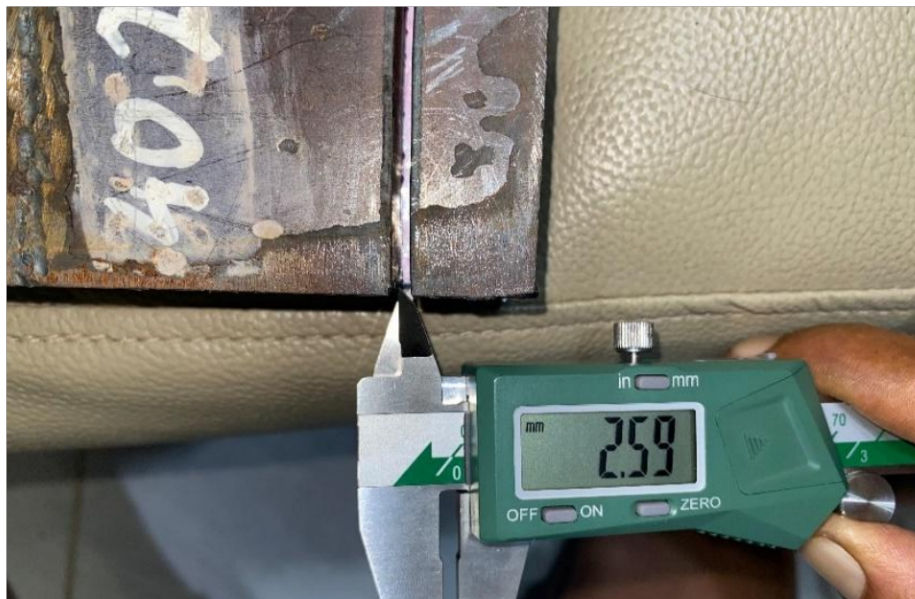
Gambar 4.3 Hasil Pemotongan 66 A dengan Tekanan 4 Bar
