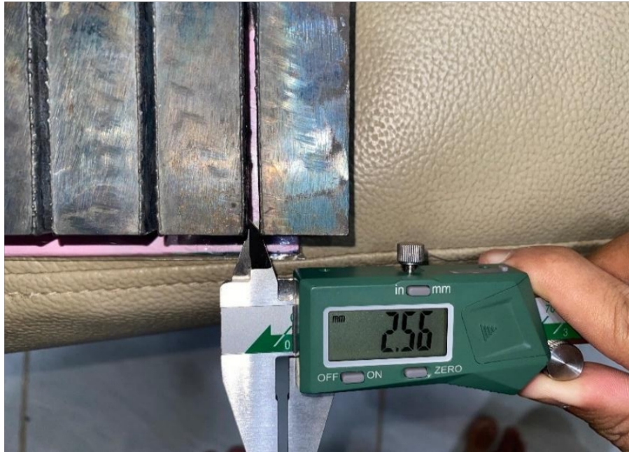
Gambar 4.8 Hasil Pemotongan 66 A dengan Tekanan 3,5 Bar
