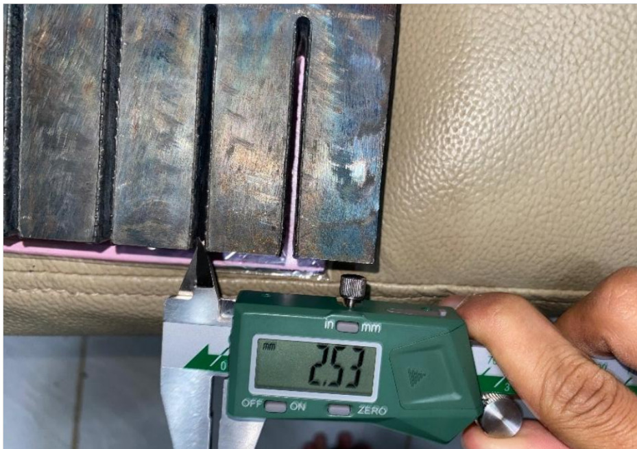
Gambar 4.7 Hasil Pemotongan 66 A dengan Tekanan 3 Bar
