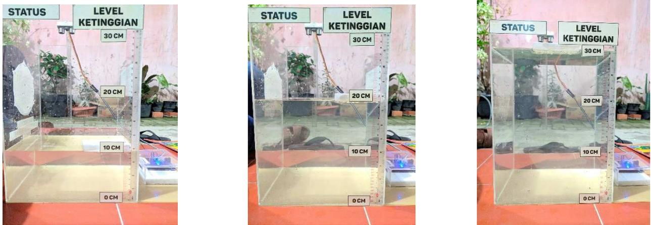
Gambar 4.10: Pengujian Prototype Sistem Monitoring Ketinggian Air
