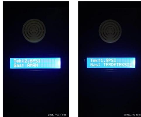
Gambar 4. 5 Tampilan Pembacaan Tekanan dan Gas pada LCD I2C
