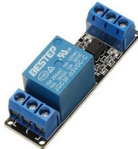
Gambar 2. 12 Relay Module 3,3V dengan Optocoupler
