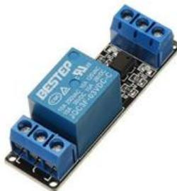
Gambar 2. 8 Relay Module 3.3V 1 Channel dengan Optocoupler
