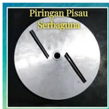
Gambar 2.2 piringan pemotong
