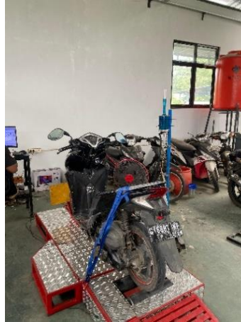
Lampiran 1. 1 sepeda motor dinaikan ke dynnotes
