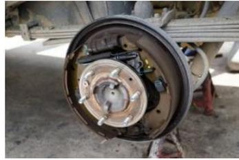
Gambar 2.9 Rem tromol (Auksi, 2023).
