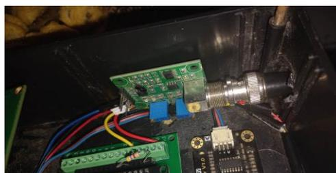
Gambar 5.1.1. 7 Rangkaian Sensor pH
