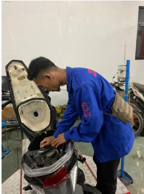
lampiran 1. 1 proses pemasangan kabel fuel pump
