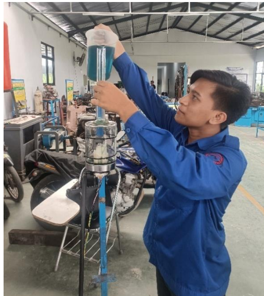
Lampiran 2 Proses memasukan bahan bakar kedalam Buret
