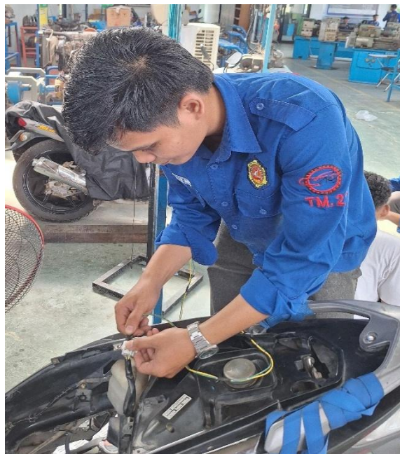
Lampiran 1.6 Pemasangan Kabel Buret Ke fuel Pump
