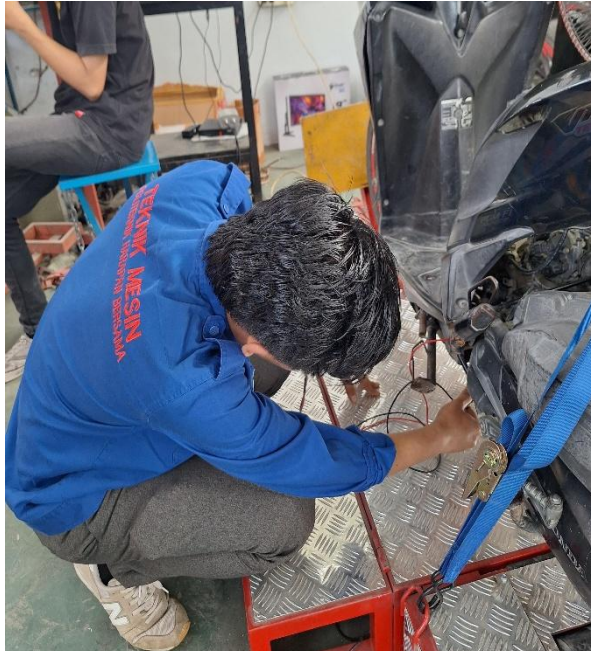
Lampiran 1.5 Pemasangan Kabel Sensor dynotest Ke Busi dan Masa Motor
