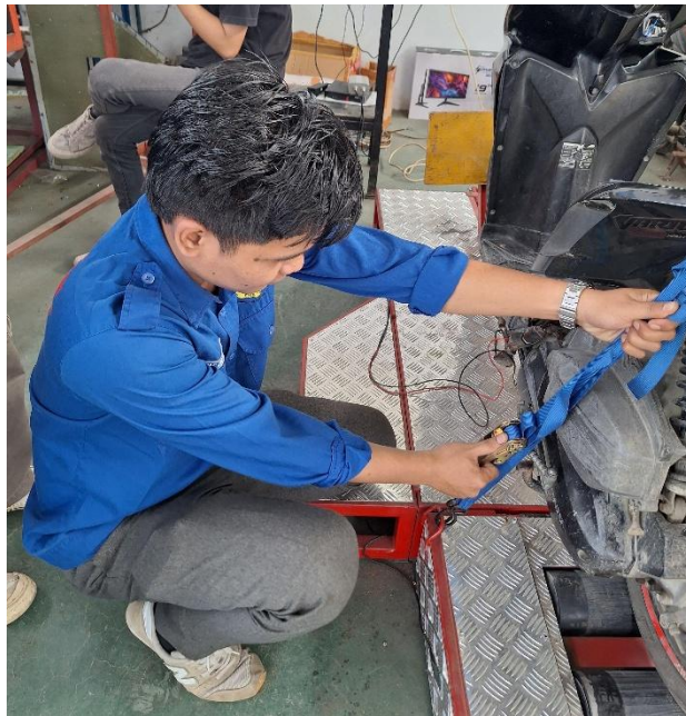
Lampiran 1.4 Pemasangan Tie Down Agar Kendaraan Stabil
