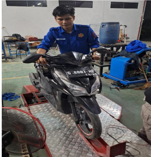
Lampiran 1.3 Memposisikan Motor Pada Dynotest
