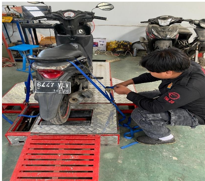
Lampiran 1. 5 Proses pasang tie down agar kendaraan tidak bergeser.
