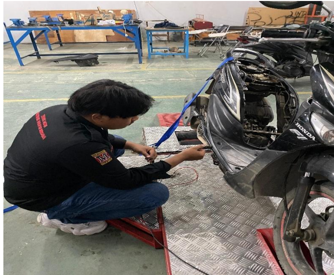
Lampiran 1. 4 Proses pemasangan kabel sensor dynotest ke busi dan masa motor.
