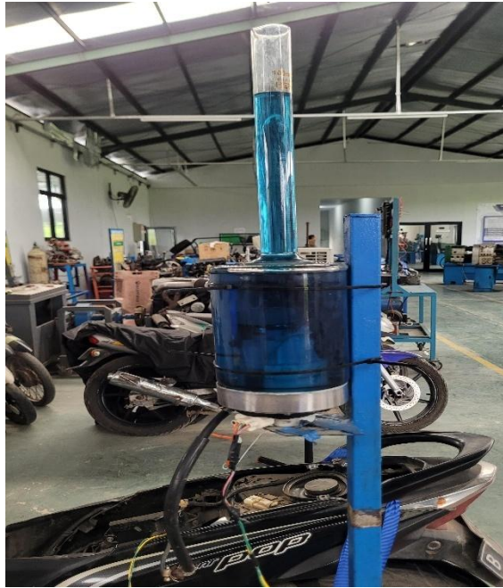
Lampiran 1. 6 Buret digunakan sebagai alat untuk menampung bahan bakar
