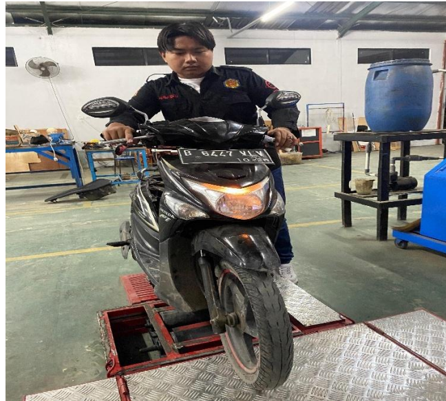
Lampiran 1. 2 Proses memposisikan motor pada dynotest
