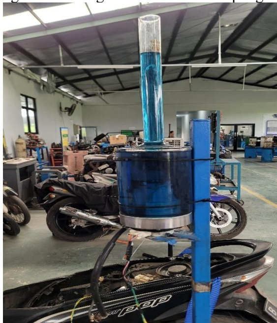
Lampiran 6 Buret digunakan sebagai alat untuk menampung bahan bakar.
