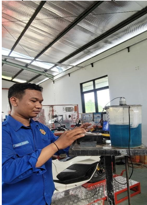
Lampiran 2 Proses pencampuran bahan bakar menggunakan mixer .
