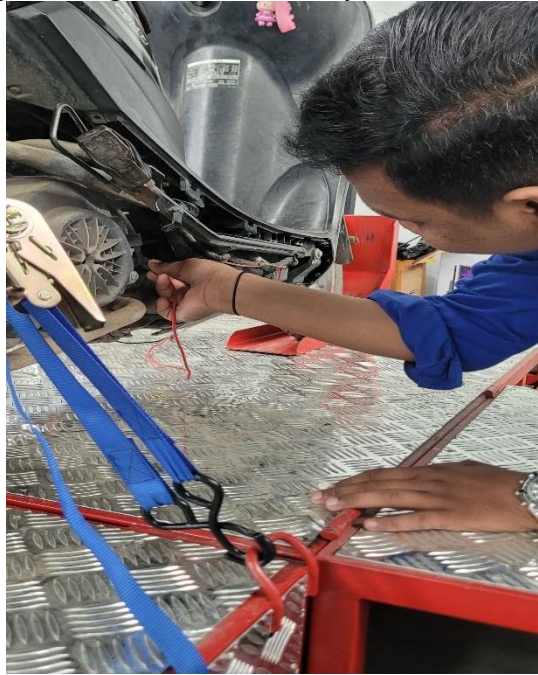
Lampiran 5 Proses pemasangan kabel sensor dynotest ke busi dan besi motor.
