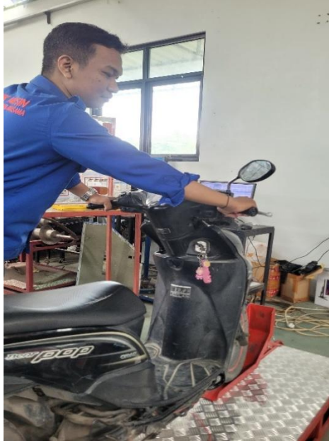
Lampiran 3 Proses memposisikan motor pada dynotest .
