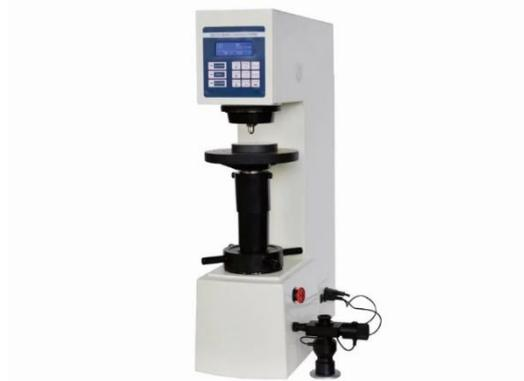
Gambar 2.19 Uji Kekerasan *Brinell*
