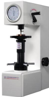
Gambar 2.27 Alat Uji Kekerasan *Rockwell*
