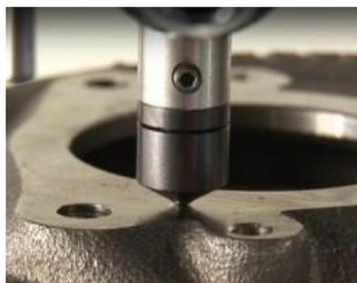
Gambar 2.26 Uji Kekerasan *Brinell*
