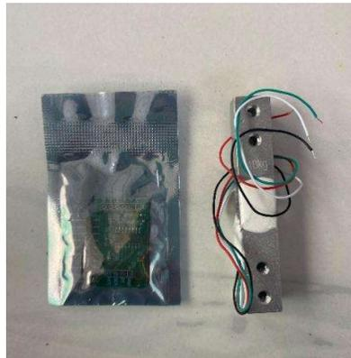
Gambar 2. 8 Sensor Berat (*Load Cell*)
