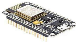
Gambar 2. 2 NodeMCU ESP8266
