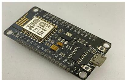
Gambar 2. 2 NodeMCU ESP8266
