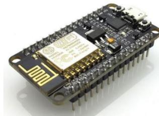
Gambar 2. 2 *NodeMCU ESP8266*
