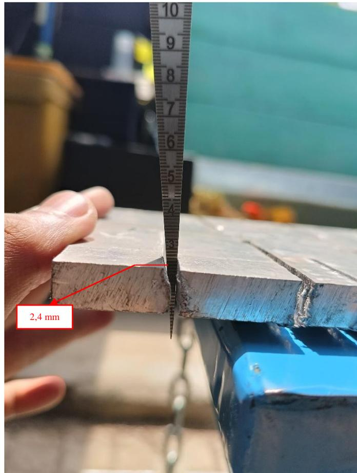
Gambar 4. 22 Pengukuran Hasil 4 Bar Pemotongan Ketiga
