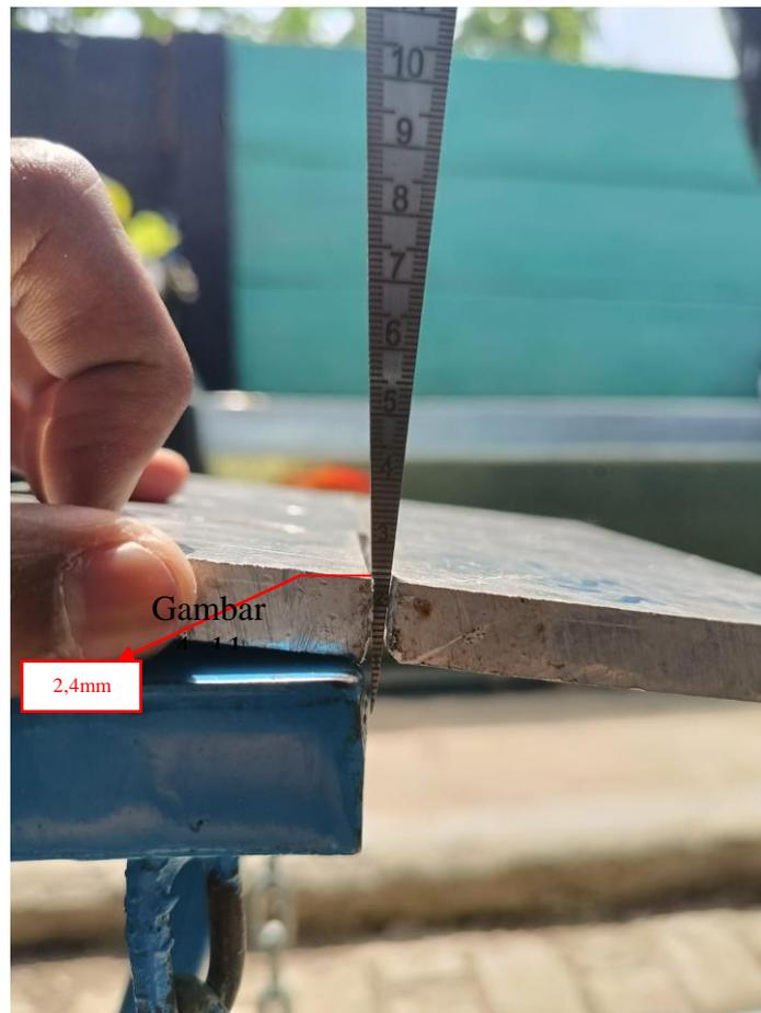
Gambar 4. 12 Pengukuran Hasil 3,5 Bar Pemotongan Kedua
