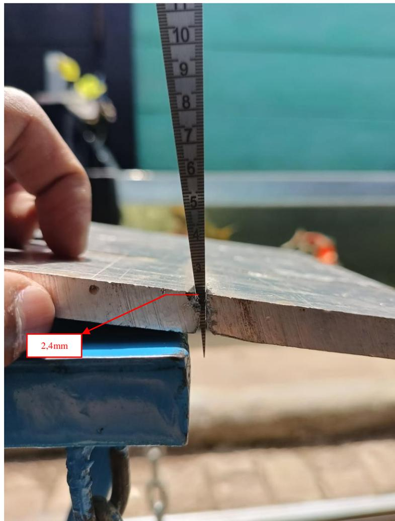
Gambar 4. 9 Pengukuran Hasil 3,5 Bar Pemotongan Pertama
