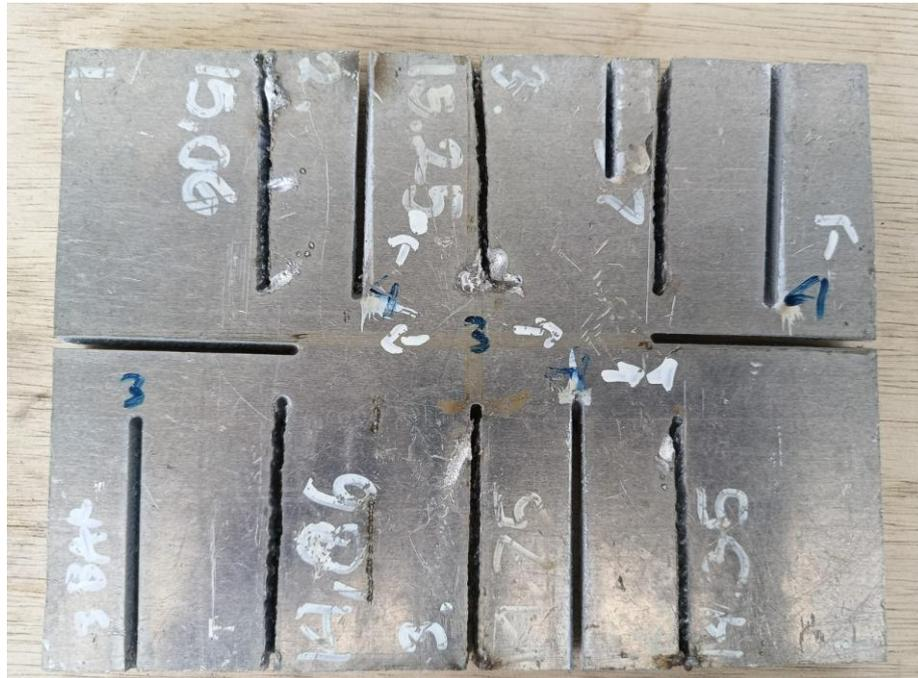
Gambar 4. 1 Hasil Pemotongan menggunakan 3 Bar
