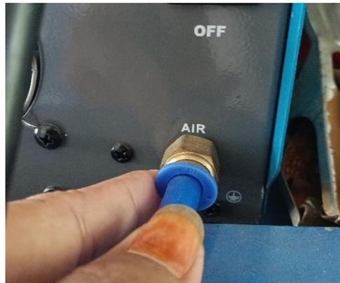
Gambar 3. 15 Memasang Selang Plasma *Cutting*
