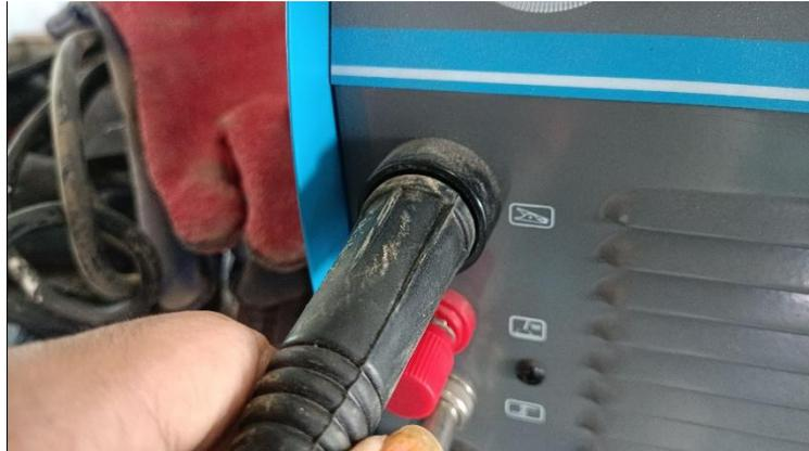
Gambar 3. 17 Memasang Kabel Massa
