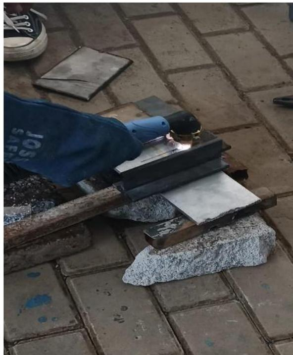
Gambar 3. 23 Proses memotong bahan uji
