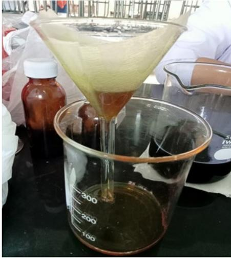
Menyaring minyak yang sudah teradsorpsi dengan menggunakan kertas saring sampai jernih atau sisa adsorben hilang
