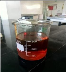
Penyiapan minyak jelantah sebelum diadsorbsi
