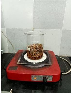
Pencampuran minyak jelantah teradsorpsi dan jahe dengan perbandingan 1:1
