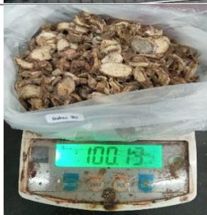
Melakukan penimbangan pada jahe yang sudah dikeringkan pada masing-masing suhu
