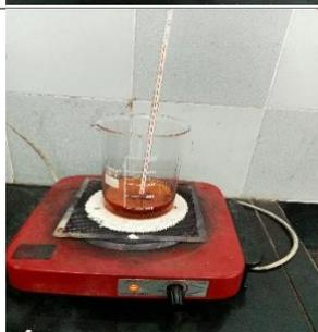
Melakukan pengukuran suhu pada minyak jelantah teradsorpsi sebelum dilakukan pencampuran dengan jahe
