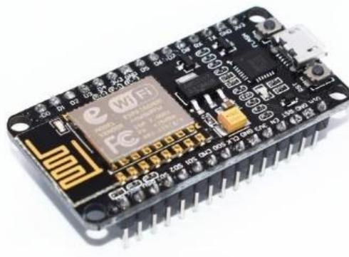
Gambar 2.4 Modul NodeMCU ESP8266
