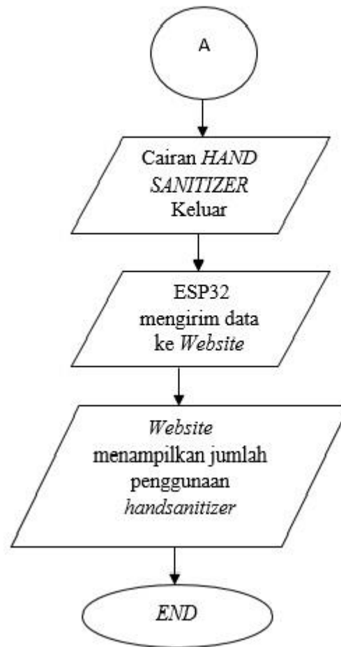
Gambar 4.2. Flowchart dari alat hand sanitizer otomatis
