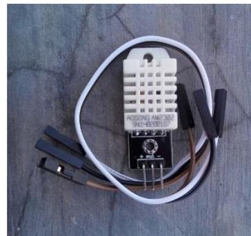
Gambar 2.3 Sensor DHT22
